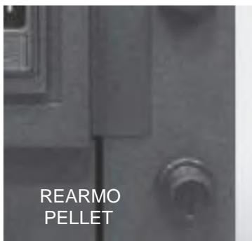
**Seguridad temperatura del depósito pellets:** en casos rarísimos en los que se verifica una temperatura excesiva en el interior del depósito de pellets, en la puesta en marcha manual, genera una alarma "ALAR-SIC-FAIL" interrumpiendo el funcionamiento de la estufa. Este dispositivo impide que exista retorno de llama hacia la tolva. El restablecimiento debe de ser efectuado por parte del cliente, quien restablece dicho dispositivo colocado en la parte posterior de la estufa.
