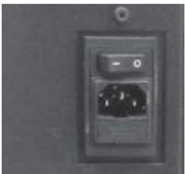
**Seguridad eléctrica:** la estufa está protegida contra los saltos bruscos de corriente por un fusible general que se encuentra en el pequeño panel de mandos ubicado en la parte trasera de la estufa. Hay otros fusibles para la protección de las tarjetas electrónicas (tarjeta madre y tarjeta intercambiador) que están situados en éstas últimas.
